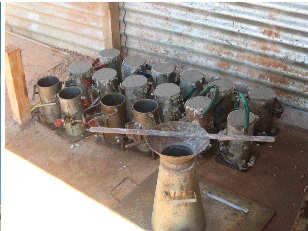
Foto 27 – Ensaios e Moldagem de Corpo de Prova, ref. Item 09.01 do Memorial descritivo
